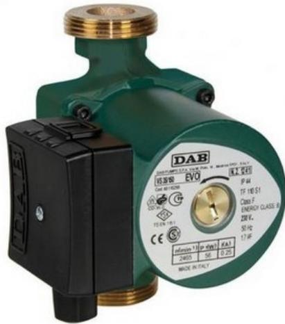
Pompa di circolazione per impianti di acqua calda sanitaria di tipo chiuso e pressurizzato o a vaso aperto. Idonea anche per impianti a energia solare. Corpo pompa in bronzo. Campo di funzionamento: da 0,5 a 3,6 m3/h con prevalenze fino a 6 metri. Campo di temperatura del liquido: da -10 °C a +85°C (per impieghi sanitari) + 110°C (per altri impieghi). Massima pressione di esercizio : 10 bar. Fornito senza bocchettoni (Articolo 412-422).
