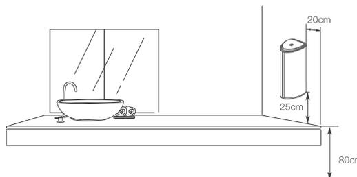
NOTA: se la superficie sottostante è in acciaio, la distanza dal sensore dev'essere di almeno 35 cm.
