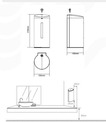
NOTA: se la superficie sottostante è in acciaio, la distanza dal sensore dev'essere di almeno 35 cm.
