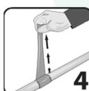
Avvolgere mantenendo il nastro in tensione accertandosi che ad ogni giro il nastro appoggi in parte, almeno a metà, su se stesso
