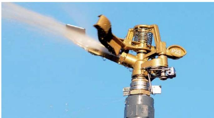
**NB:** i dati di raggio, gittata e diametro sono calcolati in assenza di vento e possono essere ridotti del 25% regolando la vite rompigitto.
