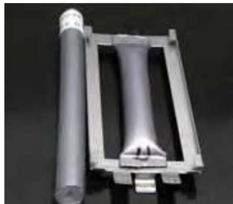
*A sinistra il campione a zero ore (prima dell'esposizione) e a destra il campione sottoposto al test di invecchiamento accelerato dopo 4.000 ore di esposizione.*
