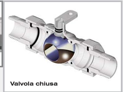
Nel caso sia necessario intervenire manualmente sull'apertura o chiusura della valvola, si potrà ruotare il perno con l'ausilio di un cacciavite.
