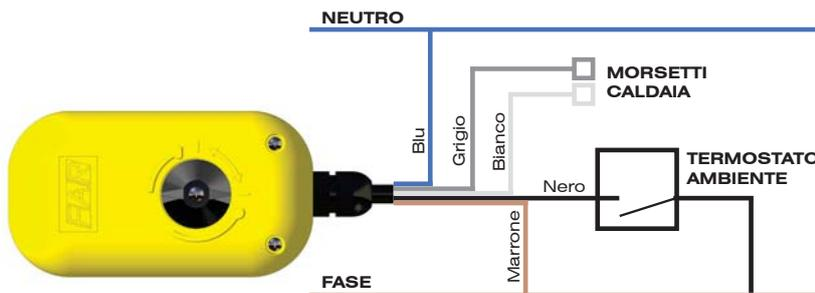
La presenza del microinterruttore ausiliario (contatto pulito) interno collegato ai cavi grigio e bianco, essendo indipendente dal circuito del servocomando, permette l'allacciamento di più servocomandi in parallelo per governare un'unica apparecchiatura come ad esempio la pompa o la caldaia. Nel caso si debba comandare l'avviamento della pompa già presente in caldaia, basta collegare i cavi di colore grigio e bianco ai due morsetti predisposti (sulla caldaia) per l'allacciamento al termostato.
