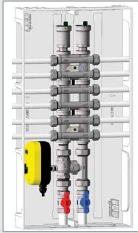
Negli impianti soggetti alla formazione di condensa (caldo-freddo), è consigliato l'utilizzo del distanziale art.9003 per evitare che le gocce di condensa possano danneggiare l'elettronica del servocomando.
