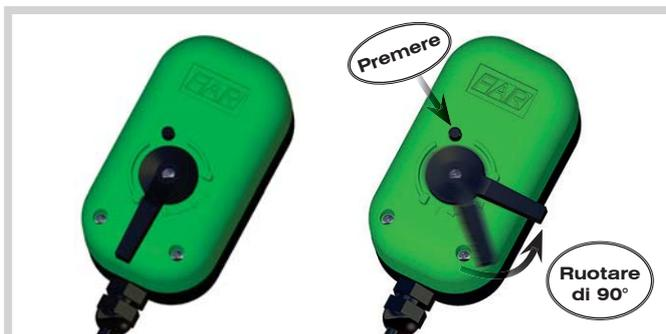
I servocomandi elettrici **Art.3005-3006** e **Art.3007-3008**, sono dotati di sblocco manuale che permette, in caso di mancanza di corrente elettrica, di poter modificare manualmente la posizione della valvola.
