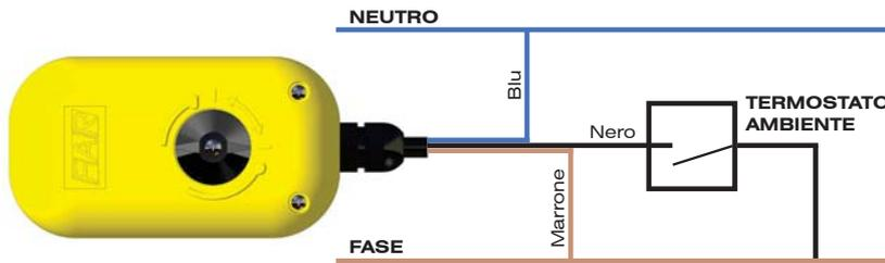
Collegare il cavo di colore blu al neutro dell'alimentazione, il cavo di colore marrone alla fase diretta ed il cavo di colore nero al termostato ambiente.
