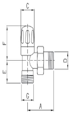
Detentore a squadra cromato attacco tubo rame e plastica. Angle chrome plated lockshield - connection for copper and plastic pipe.
