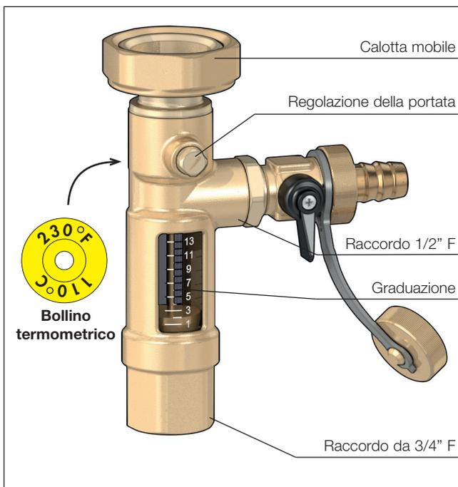
Sul retro del flussometro è posizionato un bollino termometrico che segnala l'eventuale superamento della temperatura massima consentita (110 °C): colore bianco = temperatura non superata; colore scuro = temperatura massima superata. L'asportazione del bollino fa decadere la garanzia del produttore sul componente.
