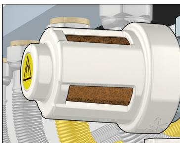
La conformazione della valvola di intercettazione consente di effettuare la pulizia degli elementi interni scaricando la sola acqua contenuta nel filtro. Per intercettare i filtri con attacchi in linea cod. 545910 e 545912 è necessario ruotare la leva di chiusura in senso antiorario.
