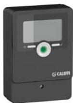
Regolatore digitale con sinottico funzionale per riscaldamento e raffreddamento completo di sonda di mandata ad immersione con pozzetto e sonda di ritorno Pt1000 Ø 6 mm. Sonda climatica opzionale. Campo di temperatura di regolazione: 5-95 °C. Alimentazione: 230 V - 50/60 Hz. Grado di protezione: IP 20 / EN 60529. Lunghezza cavo sonde: 1,5 m.
