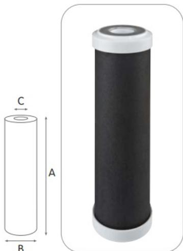
Cartucce con blocco di carbone attivo estruso "ecologico" di origine vegetale, consente la filtrazione di sedimenti fini e riduzione del sapore e odore di cloro (CTO), composti organici volatili (VOC). Con carbone argentizzato per effetto batteriostatico, filtrazione 0,3 micron.
