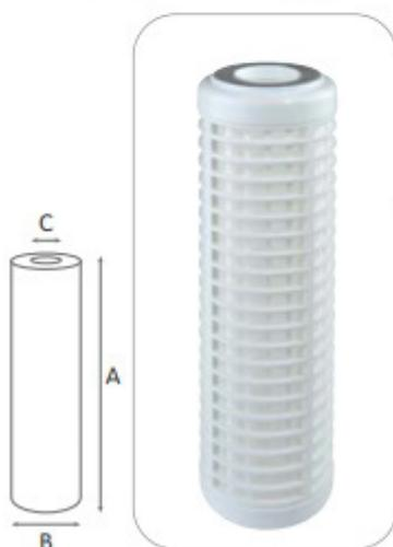
Le cartucce in rete lavabile con filtrazione nominale 50 micron consentono un flusso uniforme d'acqua e perdite di carico molto basse. Le cartucce vengono prodotte senza colla e sigillanti, e le reti vengono stampate sul supporto rigido strutturale (armatura). Cartucce con supporto rigido progettate per elevata resistenza e durata, con altezza da 4" a 20".
