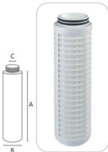
Le cartucce in rete lavabile con filtrazione nominale 50 micron consentono un flusso uniforme d'acqua e perdite di carico molto basse. Le cartucce vengono prodotte senza colla e sigillanti, e le reti infatti vengono stampate sul supporto rigido strutturale (armatura). Cartucce con supporto rigido progettate per elevata resistenza e durata, con altezza 10" e 20".
