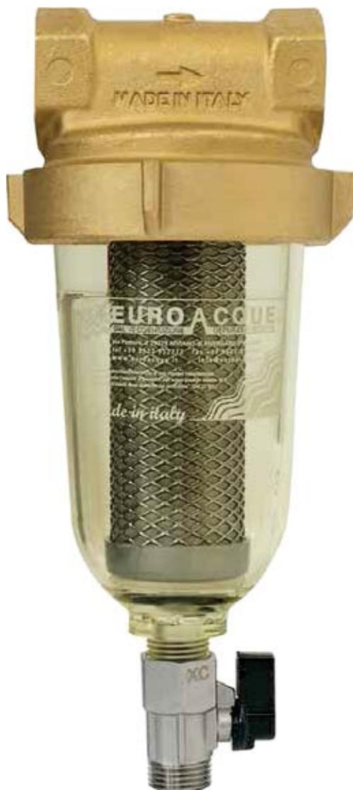
**DESCRIZIONE.** Filtro dissabbiatore autopulente con testa e ghiera in Ottone, cartuccia in Acciaio Inox e scarico autopulente manuale. L'acqua entra nel filtro e quindi, convogliata nella cartuccia, esce filtrata. Sono dotati di rubinetto di scarico che permette di espellere la sabbia senza smontaggio. Cartuccia batteriostatica con nano argento.
