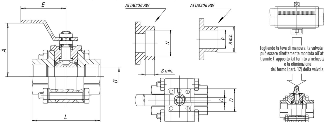
Togliendo la leva di manovra, la valvola ARGOS può essere direttamente montata all'attuatore tramite l'apposito kit fornito a richiesta K1GA, e la eliminazione del fermo (part. 12) della valvola.
