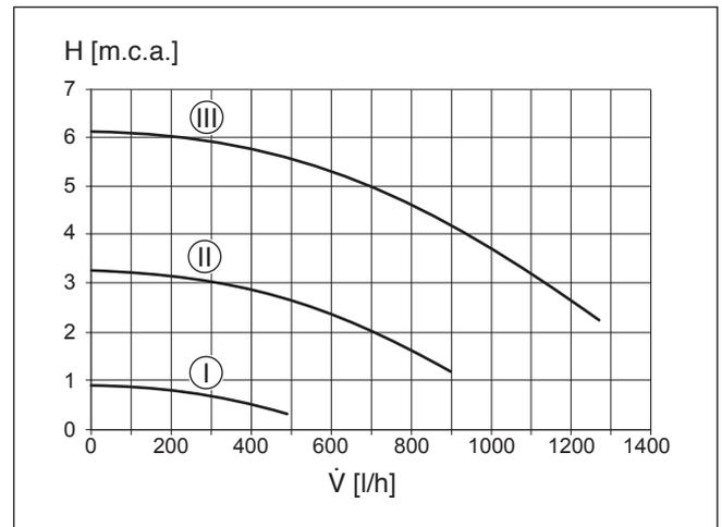
**Curve caratteristiche del circolatore di serie in GC2300W 24 C, GC2300W 24/30 C e GC2300W 24 P**
