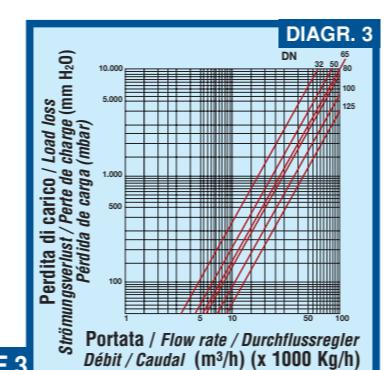
**DIAGRAMMI PERDITE DI CARICO - LOAD LOSS-FLOW RATE - DIAGRAMM DURCHFLUSS-STRÖMUNGSVERLUST**
