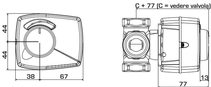
Dimensioni di installazione per l'attuatore serie ARA600 con miscelatori termostatici ESBE serie VRG100, VRG200, VRG300, VRB100 e VRH100
