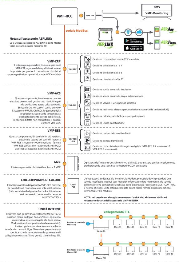
ATTENZIONE: Nel caso una (o più) zone siano gestite usando un ventilconvettore FCWI (per ognuno dei quali è necessario dotarsi dell'interfaccia VMF-485LINK), queste zone non potranno avere unità Slave.
