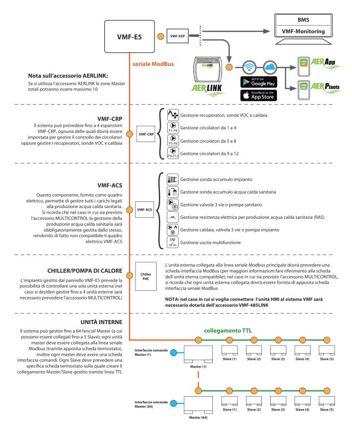
**ATTENZIONE:** Nel caso una (o più) zone siano gestite usando un ventilconvettore FCWI (per ognuno dei quali è necessario dotarsi dell'interfaccia VMF-485LINK), queste zone non potranno avere unità Slave.
