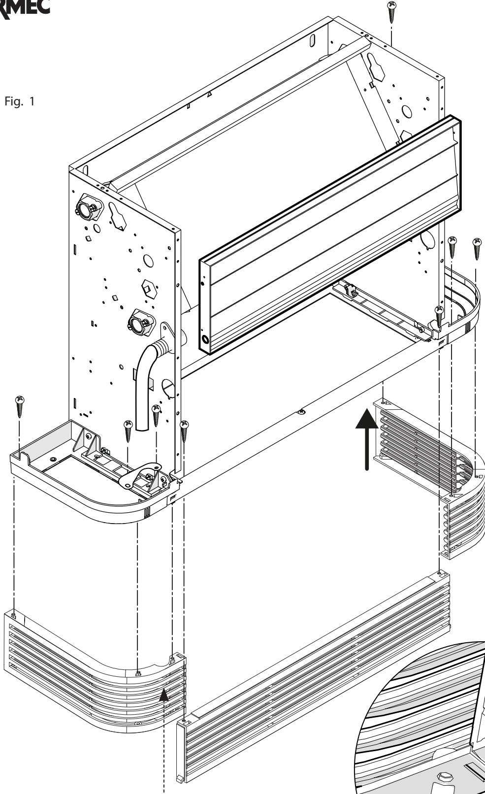
L'elemento laterale con scanalatura deve essere installato nel lato degli attacchi idraulici
