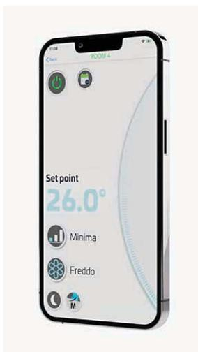
E', inoltre, possibile programmare in maniera completa il funzionamento del ventilconvettore con più fasce orarie per ciascun giorno della settimana in maniera semplice e intuitiva: questo consente di coniugare il massimo comfort con la massima efficienza energetica.
