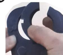
Premere il pulsante (1) per inserire l'inserto nell'asse di alloggiamento (11). N.B. rimuovere la batteria dall'utensile prima di inserire l'inserto.
