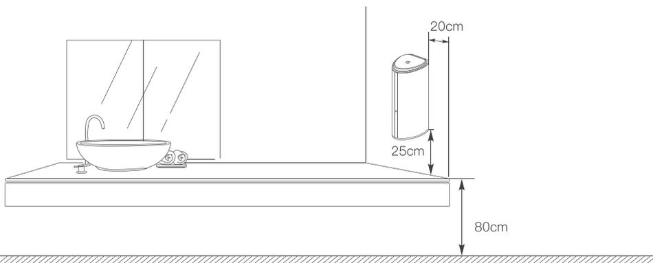
NOTA: se la superficie sottostante è in acciaio, la distanza dal sensore dev'essere di almeno 35 cm.
