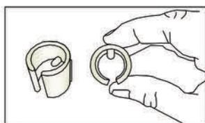
**A.** Montare le "pinze con piolo" in plastica in corrispondenza dei fori sulle maniglie di appoggio ( vedi figure sopra ) . Accertarsi che i pioli sia ben inserito nel foro.
