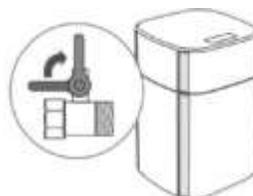
O Qualora il dispositivo risulti difettoso, chiudere subito il rubinetto a muro e contattare il servizio di assistenza.
