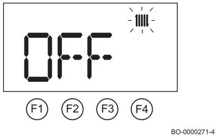
Per disabilitare il funzionamento della caldaia in riscaldamento:
