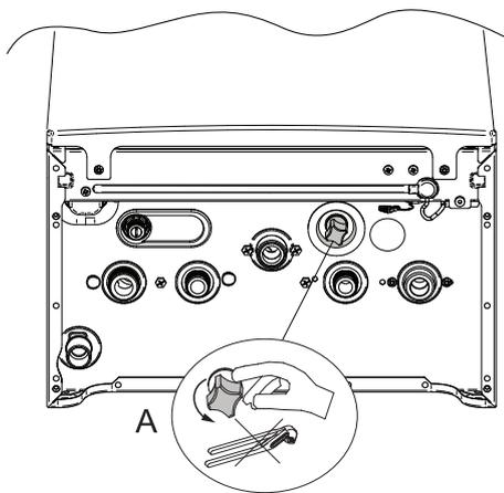
1. La manopola di caricamento è di colore azzurro ed è posizionata sotto alla caldaia. Per caricare l'impianto agire come di seguito descritto
