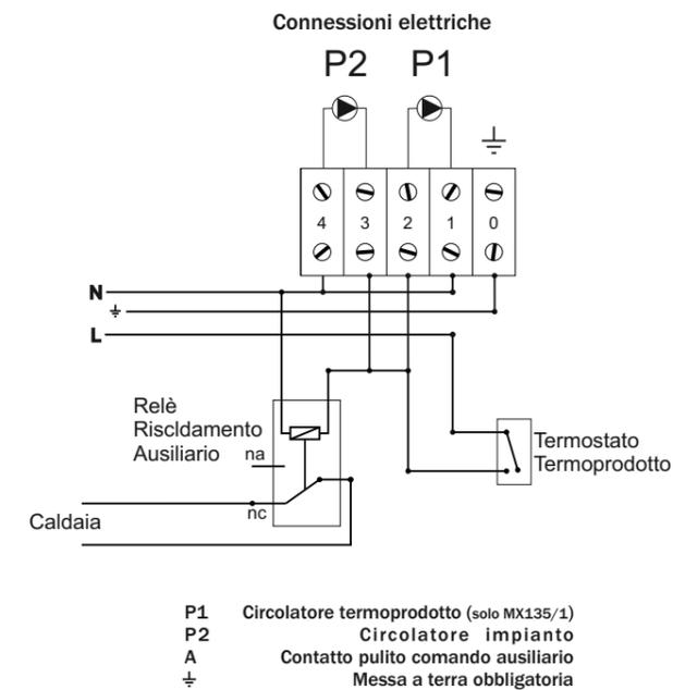
**Nel caso venga installata la centralina elettronica di controllo seguire le istruzioni a corredo per il cablaggio**
